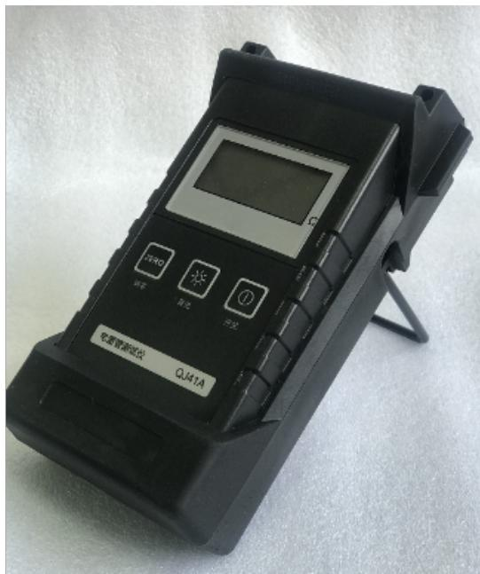
上海双特电工带您了解电雷管测试仪的注意要点四: 1. 在仪表串联到待测回路之前,应先将回路中的电源关闭。测量时应使用正确的输入端口和功能档位,如不能估计电流大小,应从量程开始测量。2. 大于 $10A$ 电流测量时,因A输入端口没有设置保险丝,为了安全使用每次测量时间应小于10秒,间隔时间应大于15分钟。当表笔插在电流端子上时,切勿把表笔测试针并联到任何电路上,会烧断仪表内部保险丝和损坏仪表。完成所有测量操作后,应先关断电源再断开表笔与被测电路的连接。对大电流的测量更为重要。3. 电雷官电阻测量1) 将红表笔插入“ $\Omega$ ”插孔,黑表笔插入“COM”插孔。2) 将功能开关置于“ $\Omega$ ”测量档,并将表笔并联到被测电阻上。3) 从LCD上直接读取被测电阻值。如需保持数据,将面板上蓝色按钮“HOLD”键按下即可。辽宁电雷管测试仪厂商电雷管测试仪如何发挥重要作用? 上海双特告诉您。
