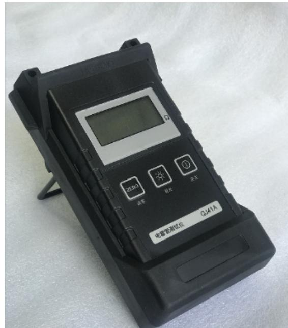
在低阻测量时，表笔会带来约 $0.1\Omega$ - $0.2\Omega$ 电阻的测量误差。为获得读数，应首先将表笔短路，记住显示值，在测量结果减去表笔短路显示值，才能确保测量精度。如故哦表笔短路时的电阻值不小于 $0.5\Omega$ 时，应检查表笔是否有松脱现象或其他原因。测量 $1M\Omega$ 以上的电阻时，可能需要几秒钟后读数才会稳定。这对于高阻的测量属正常。不要输入高于直流 $60V$ 或交流 $30V$ 以上的电压，避免伤害人身安全。在完成所有的测量操作后，要断开表笔与被测电路的连接。上海双特电工带您了解电雷管测试仪的注意要点五：如果被测电阻开路或阻值超过仪表\*大量程时LCD显示“1”。当测量在线电阻时，在测量前必须先将被测电路内所有电源关断，并将所有电容器放尽残余电荷，才能保证测量正确。
